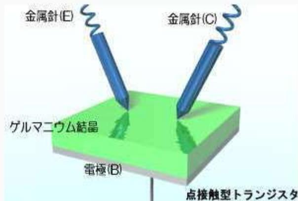
図のように、金属針(E)にプラスの電圧を、金属針(C)にマイナスの電圧をかけたとき、電極(B)の電圧次第で、E(emitter)とC(collector)の間に電流が流れたり流れなかったりすることが分かったのだ。これこそ、現在「**バイポーラトランジスタ**」と呼ばれているものの原型だった。今では、このトランジスタを「**点接触型トランジスタ**」と呼んでいる。この理論の確立にはバーディーンが大きく貢献した。
