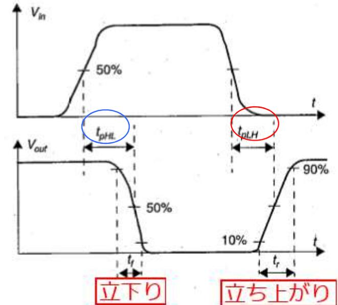
リングオシレータをインバータ一段で構成した場合、回路動作の遅延のためインバータの出力( $V_{out}$ )が反転する前の状態が入力( $V_{in}$ )に帰還されてしまいます。
